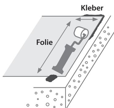
2. Anschließend Folienkanten mindestens 15 bis 20 mm überdecken mit RALMO<sup>®</sup>-EPDM Folienkleber oder RALMO<sup>®</sup>-Montage FIX ALL SEASONS (z.B. bei Bitumen)
